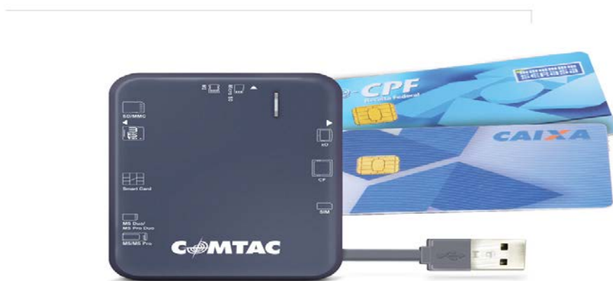
Figura 5 - Modelo de smart-card e o leitor com cabo usb
