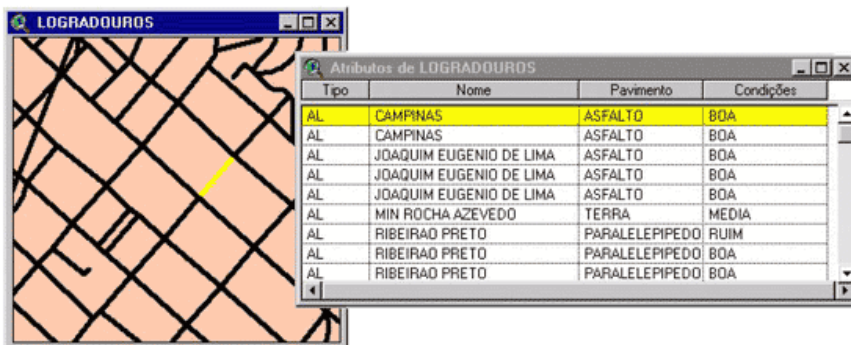
Figura 2: Trechos de logradouro e seus atributos: Nome, Tipo, Pavimento, Condições
